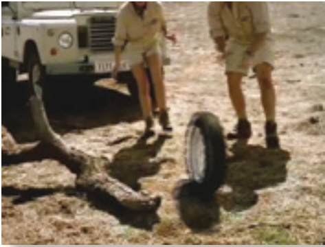
Исходное чересстрочное изображение, воспроизводимое на прогрессивном экране без изменения типа развертки. Видны зубчатые артефакты вокруг покрышки и ее тени, а также на руках и ногах людей
